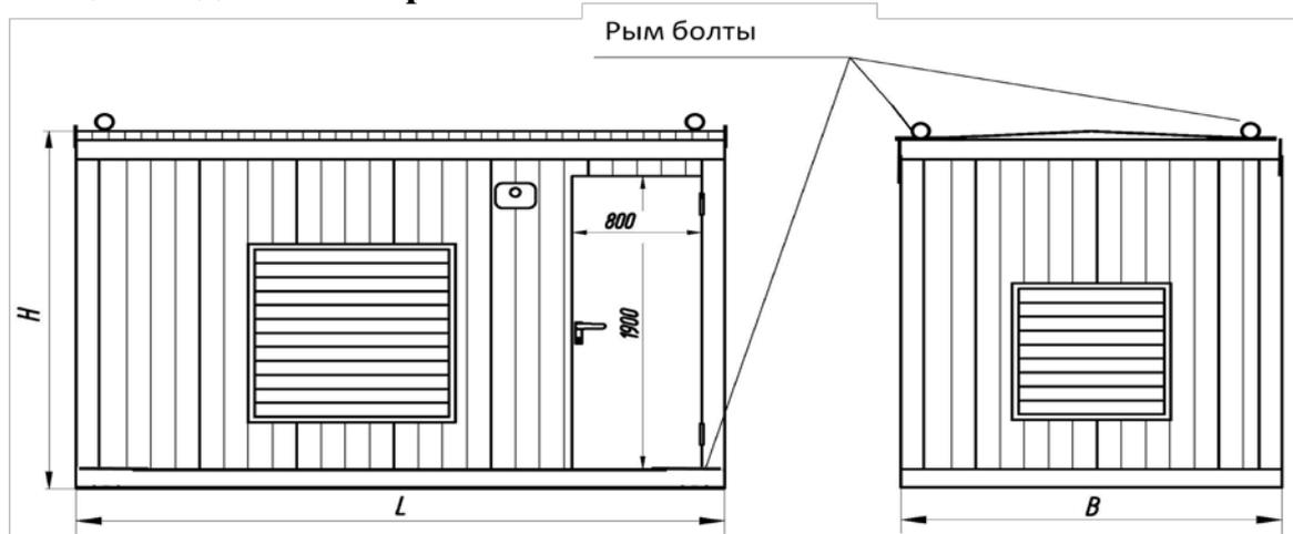
**Общий вид контейнеров «ПБК» с дополнительным отсеком.**
