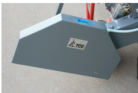
Откидная крышка/навесная защита диска
