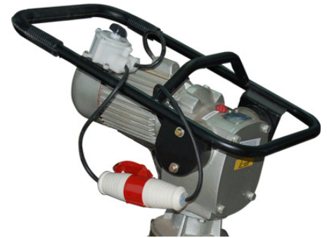
вилка и розетка для подключения
